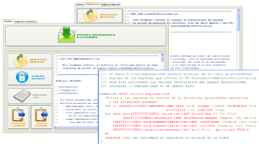
Figura 7. Ejemplo de una regla Jess de los módulos de decisión y de las interfaces para su gestión.
